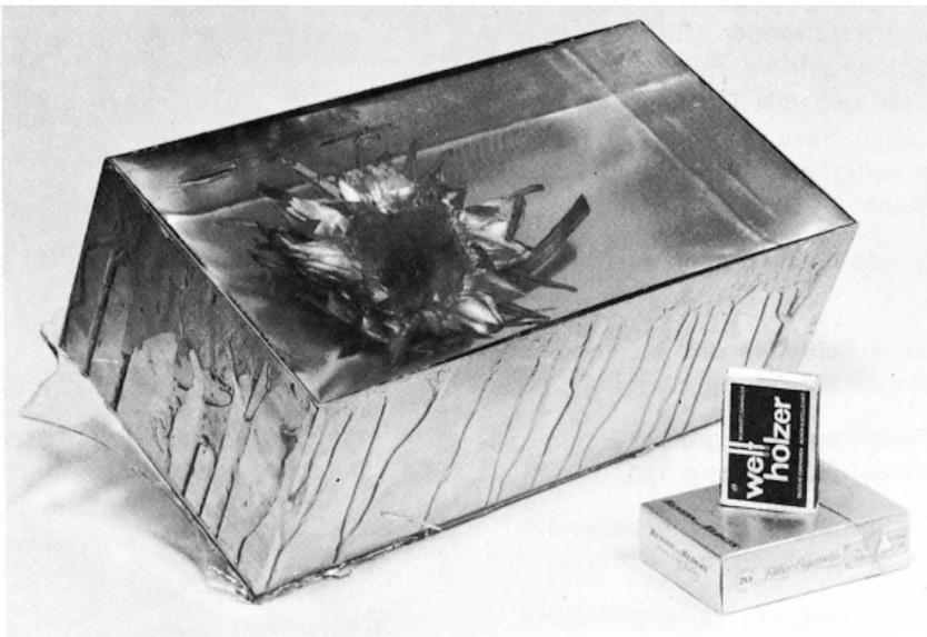
*Ein großer Gießharzblock mit einer eingegossenen Blume kurz vor der Entformung.
