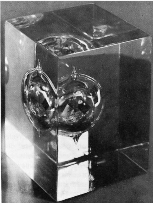
*Ein eingegossenes Radiometer.
