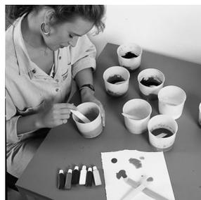
Durch Vermischen verschiedener Farbtöne lassen sich auch Zwischenfarbtöne erzielen. Bei Einsatz von weißer Abtönpaste wird aber keine Aufhellung, sondern nur eine Trübung erreicht, die Transparenz der Einfärbung wird verringert.
