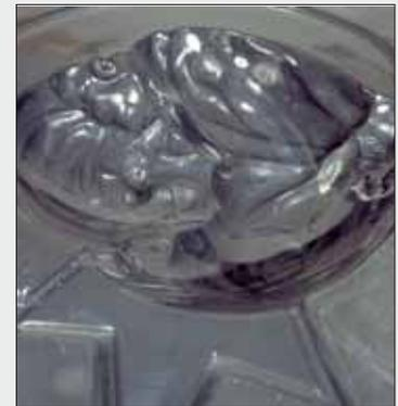
Dank ihrer hohen Tiefziehfähigkeit lässt sich VAKUFLEX-Folie auch in tiefe Formen mit komplizierter Formgebung als Trennebene und als Abdeckung hineinziehen. In jedem Fall wird mit dem Folienverfahren die Styrolemission drastisch gesenkt.
