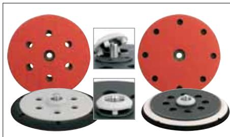
Schleifteller für den universellen Einsatz von Grob- bis Endschliff. Für alle handelsüblichen Maschinen durch Spezialadapter und zwei unterschiedliche Schrauben (M8 und 5/16") geeignet. Empfohlener Körnungsbereich: P 80 – P 500
