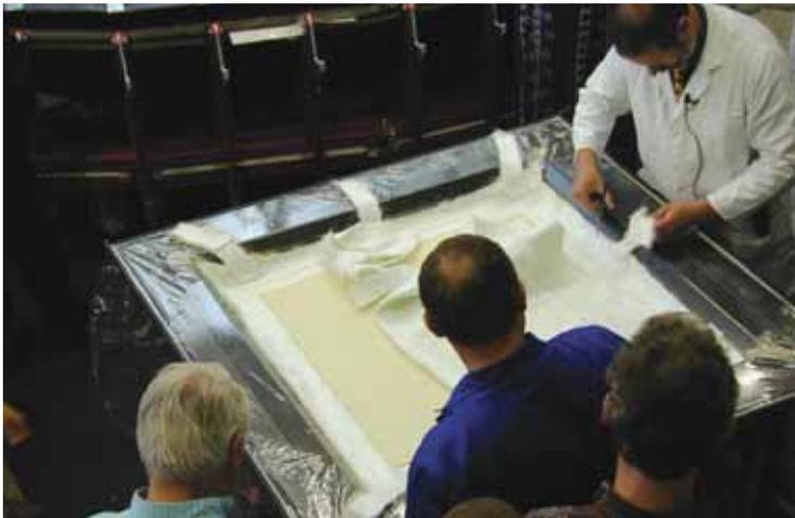
Die vordere Glaslage und der (gerillte) Schaumkern sind eingelegt, die hintere Mattenlage ist vorbereitet. Die Steiger werden plaziert.
