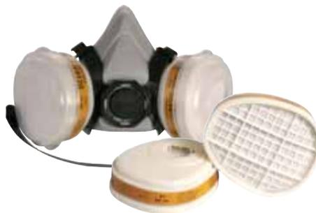
Spritzmaske mit auswechselbaren Kohlefiltern und Vorfiltern. Die Maske schützt vor Lösemitteln und organischen Dämpfen. Prüfung CE 0120 / EN 140.
