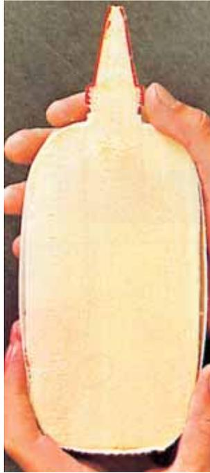
Die durchgesägte Schüttelflasche beweist die Qualität und Feinzeligkeit des gehärteten Schaumes. Das Schaumergebnis ist maschinengeschäumten Produkten ebenbürtig.
