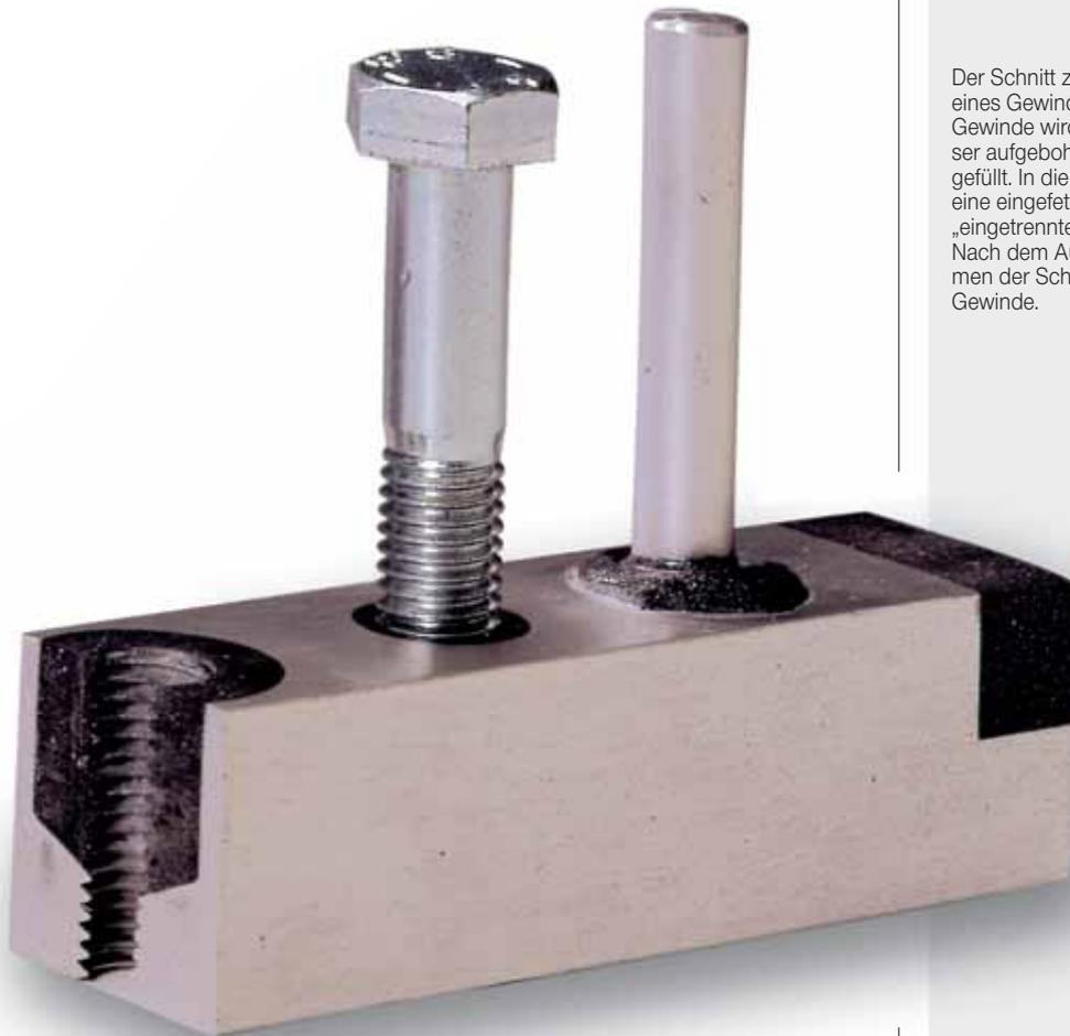
Der Schnitt zeigt die erfolgte Reparatur eines Gewindes. Das ausgebrochene Gewinde wird mit größerem Durchmesser aufgebohrt und mit HAFSTAHL gefüllt. In die noch pastöse Masse wird eine eingefettete oder mit Trennmittel „eingetrennte“ Schraube eingesetzt. Nach dem Aushärten und dem Entnehmen der Schraube entsteht so ein neues Gewinde.
