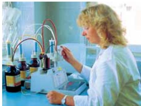
Hier wird der Wassergehalt einer Flüssigkeit am sogenannten »Karl-Fischer-Gerät« geprüft. Mit modernen Laborgeräten ist so eine komplizierte Messung in wenigen Minuten durchgeführt.
