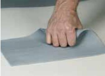
Elastische Formen aus 2-komponentigem Polyurethan werden in der Betonindustrie wegen ihrer außerordentlichen Beständigkeit gegen die alkalischen Bestandteile im Beton eingesetzt.
