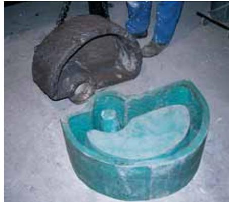
Auch gegen die alkalischen Bestandteile von Beton ist SILASTIC® S sehr gut beständig. Diese Form kann täglich einmal entschalt werden, wobei auch große Kräfte bei der Entformung ohne Schaden verkraftet werden.
