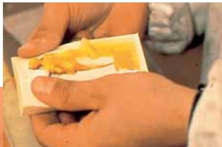
Sehr weiche, reißfeste Abformmassen ermöglichen die Duplizierung von komplizierten Formteilen ohne die Gefahr, daß bei der Entformung dünnwandige Details abgebrochen werden.
